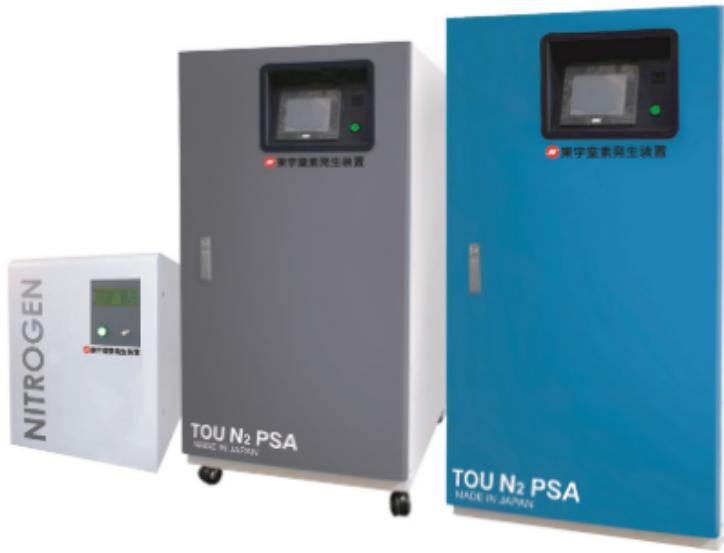
这类发生器的主要优点是流量大，实验室级别产品一般在50L/min上下，并可随意扩充，同时寿命长，膜组件作为重要部件，在空气源稳定的情况下，寿命可达10年，且维护成本极低；缺点是氮气纯度不能达到高纯级，膜组件目前均为进口，国内不能提供，成本较高，仪器价格也相对高。PSA变压吸附制氮利用氮气与其它气体分子在分子筛中的吸附能力差异，形成浓度差异的积累，在分子筛柱末端产出高纯度氮气。同时利用两根分子筛柱，一根吸附的同时引出一部分产品气为另一根解析，实现分子筛在线再生，整体表现即为仪器持续输出高纯氮气。
